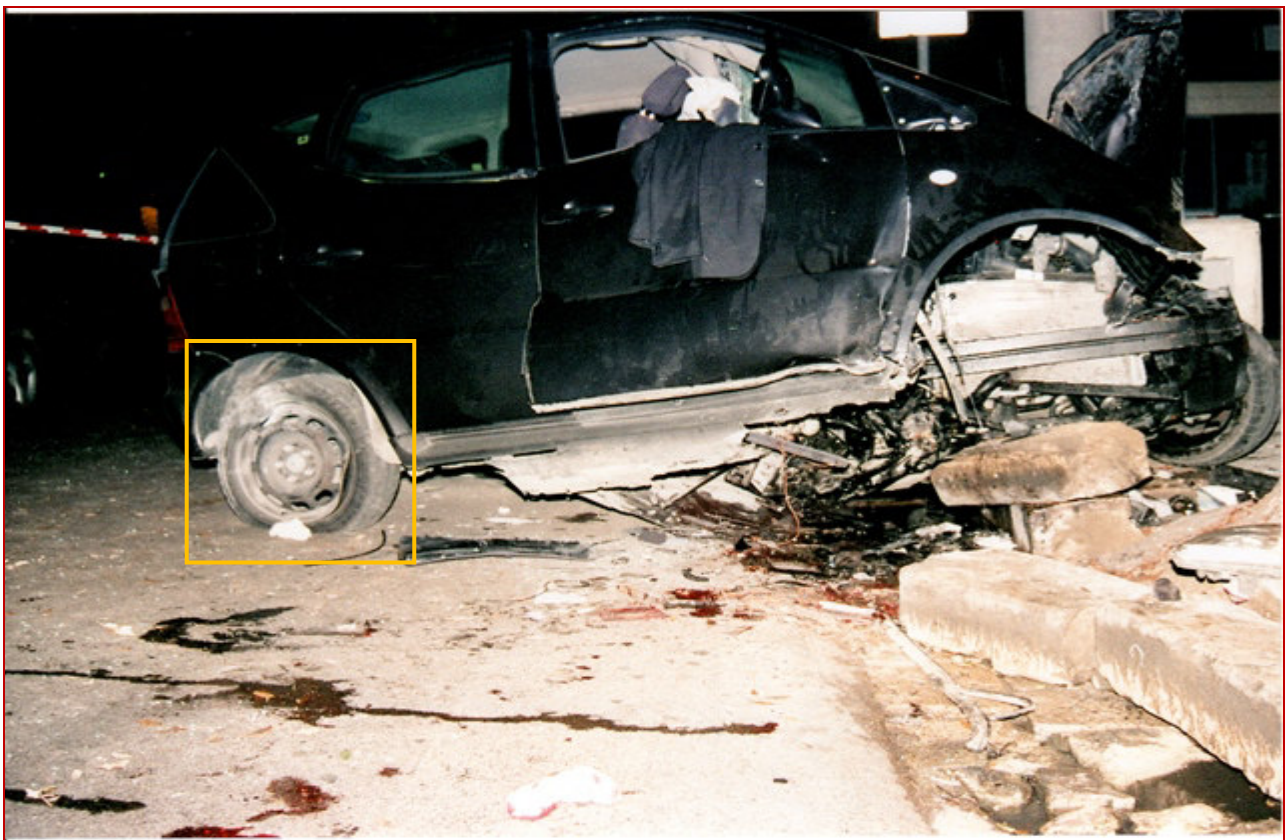
Il fotogramma evidenzia la deformazione del cerchio - ruota a seguito della collisione contro il basolato
