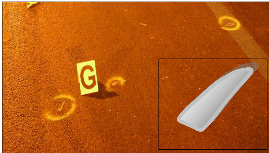
Distribuzione di frammenti di polycarbonato infranti dopo la collisione tra un autobus e un pedone.
