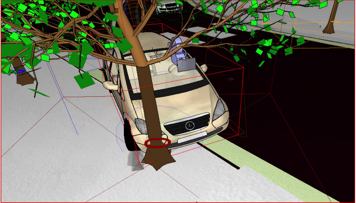
Frame a t = 1.49s : evidenza da altra prospettiva l'inizio della fase di contatto tra marciapiede e ruota posteriore destra e tra il tronco dell'albero e l'avantreno, in corrispondenza del posto del passeggero
